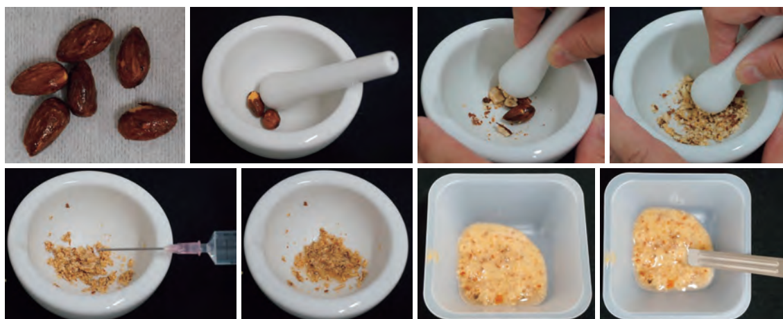
図2 ナッツ類の粗抽出液の作製方法（例）
